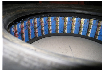
Figura 7: Pneu equipado com nanogeradores piezoelétricos - imagem retirada de https://www.inovacaotecnologica.com.br/
